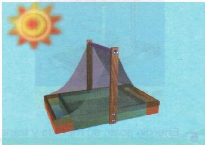
**Fig. 11.12** En los destiladores solares se utiliza la energía calorífica proveniente del Sol para obtener agua potable a partir del agua salada de los mares.
