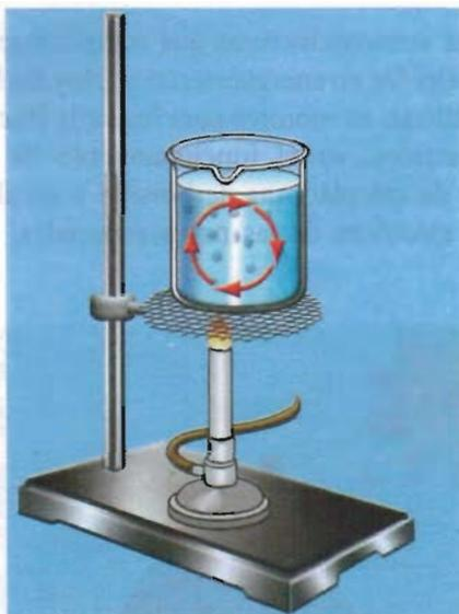
**Fig. 11.10** Calentamiento del agua por corrientes de convección.
