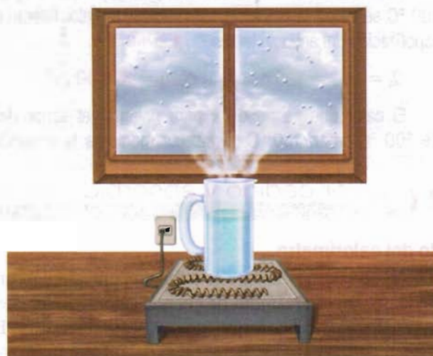
Fig 11.15 Cuando el vapor del agua entra en contacto con un cuerpo frío se condensa al ceder su calor latente de vaporización.
